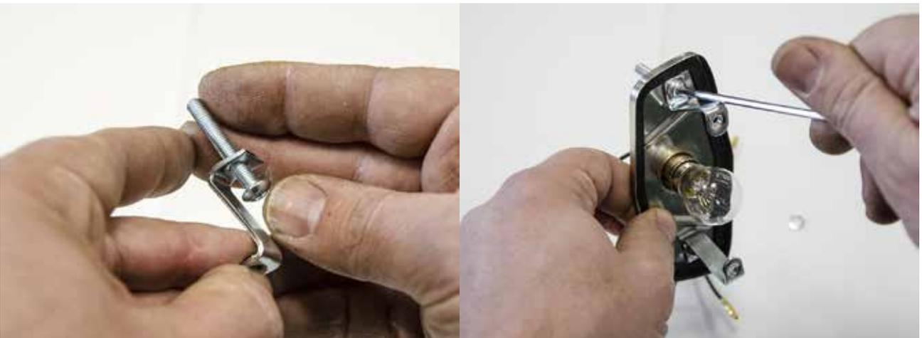
Inserire la vite in fornita e fissare di nuovo la staffa.
