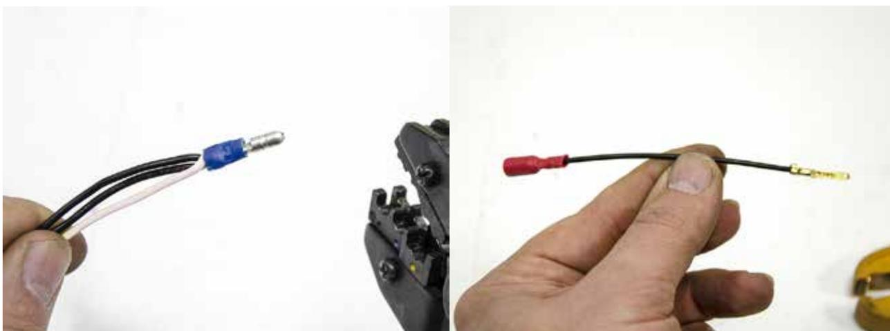
Collegare il cavo bianco del fanalino posteriore con i cavi neri degli indicatori tramite il connettore maschio fornito.
